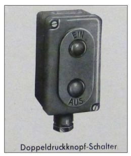
Zur Fernsteuerung der Fernschalter wurden "Doppeldruckknopf-Schalter" als Zusatzgerät benötigt. Gefertigt wurden diese in geschlossener Ausführung im Aluminium-Spritzguß-Gehäuse. Mit ihnen wurde der relativ geringe Schaltstrom (z.B. max. 4 A Schaltstrom bei 0,5 A Haltestrom für den 500V-Fernschalter) für die Betätigung der Haltespule (Elektromagnet) des Motorschutz-Fernschalters aus größeren Entfernungen, z.B. von Überwachungs-, Steuer- oder Befehls-Räumen aus, geschaltet.
