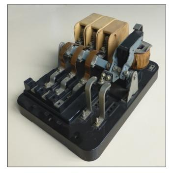
Die Sachsenwerk-Fernschalter konnten nicht nur als Motorschutz-Fernschalter eingesetzt werden, sondern konnten auch als Hauptschalter zur Steuerung von Drehstromanlagen für Antriebsaggregate, Kräne, Walzstraßen u.ä. von entfernt gelegenen Befehls- und Steuereinrichtungen aus verwendet werden.
